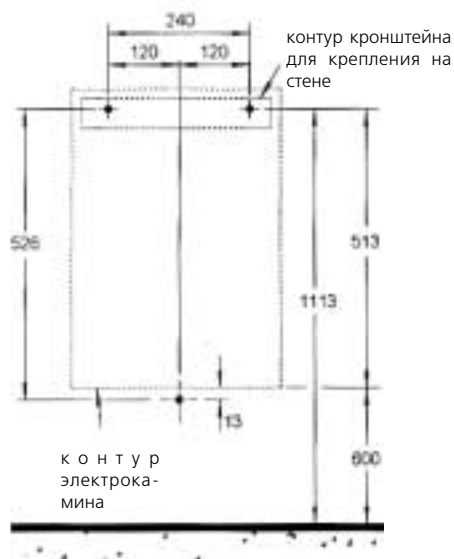
Иллюстрация 2: Рекомендуемые крепежные размеры
